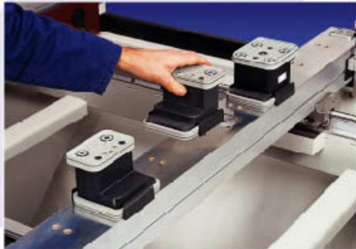
Il sistema di depressione permette il bloccaggio rapido delle ventose riducendo notevolmente i tempi per la configurazione del piano di lavoro.
