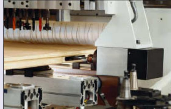
Lavorazione sede serratura con fresatore diretto.
