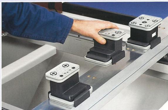
Il sistema di depressione permette il bloccaggio rapido delle ventose riducendo notevolmente i tempi per la configurazione del piano di lavoro.
