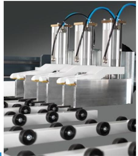
Paketklemmer in Doppelfingerausführung mit variabler Druckeinstellung.
