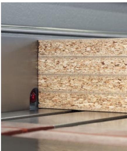
Automatische Besäumposition – Enorme Zeitersparnis durch automatische Plattengrößenmessung.
