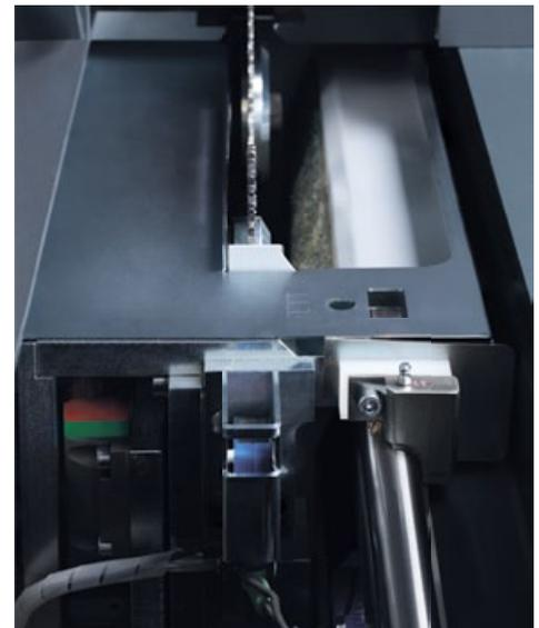
Ausgeklügelte und verschleißfreie Sägewagenführungen, sorgen bei jedem Schnitt für den perfekten 90° Winkel auch nach Jahren im industriellen Dauerbetrieb.
