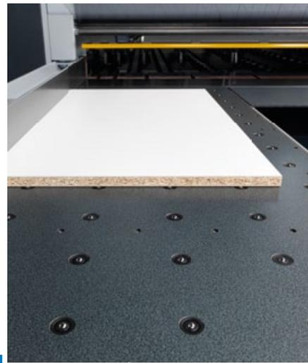
Massive Luftkissentische erleichtern die schonende Bearbeitung von schweren Werkstücken.
