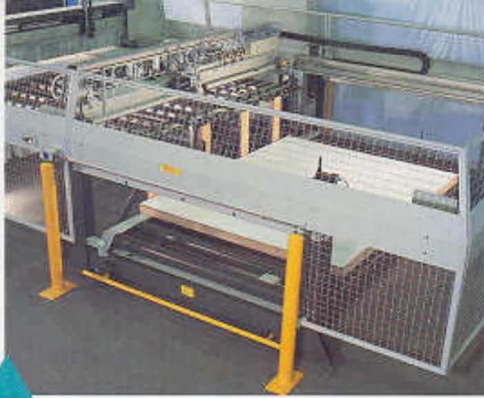
▲ Hubtisch ausgelegt mit angetriebenen Schwerlastrollenbahnen. Die Plattenstapel können von links, rechts oder von hinten auf den Hubtisch aufgebracht werden. Zum automatischen Drehen der Plattenpakete bei Kopfschnitten kann die Maschine auch mit einem Drehtisch ausgerüstet werden.
