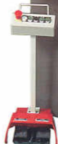
▲ Steuerung WINN 97 mit Farbgrafikbildschirm, Bedienerführung und Schnittfolgeanzeige. Da als Rechner ein PC verwendet wird, stehen vielfältige Möglichkeiten zur Kommunikation mit anderen Rechnersystemen zur Verfügung.
