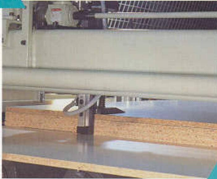
▲ Mayer Paketklemmer im Einsatz. Da jeder Paketklemmer mit 2 Spannpunkten ausgerüstet ist, ist auch bei schmalen Teilen ein sicherer Halt der Werkstücke gewährleistet.
