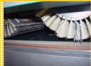
Doppelbürstenaggregat im Gleich- und Gegenlauf. Bestückung mit leicht austauschbaren Schleifsegmentbürsten.
