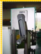
Manuelle Höhenverstellung mit Sikkozähler. Auf Wunsch kann die Höhenverstellung auch motorisch erfolgen
