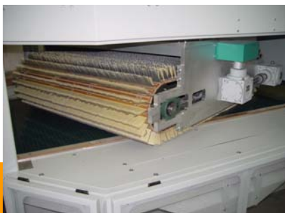
Der Roba Tech Schleifgurt mit 174 Schleifsegmenten
