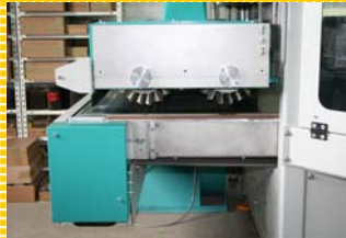
Das Doppelbürstenaggregat am Auslauf der Maschine
