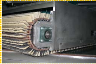
Das Schleifbürstenband für den vollflächigen schonenden Schliff
