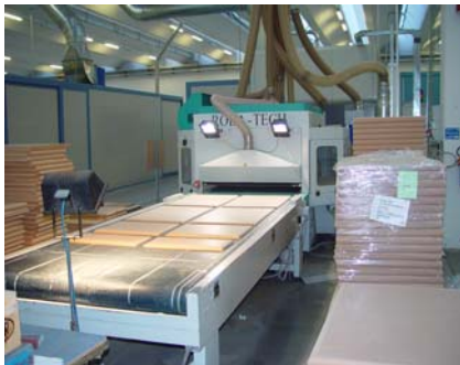
Integriert in einer Linie zur Fertigung von Membranpressteilen
