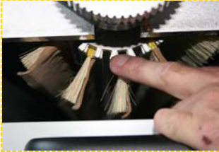
Zusätzliche Reinigungsbürste für das Vakuumtransportband
