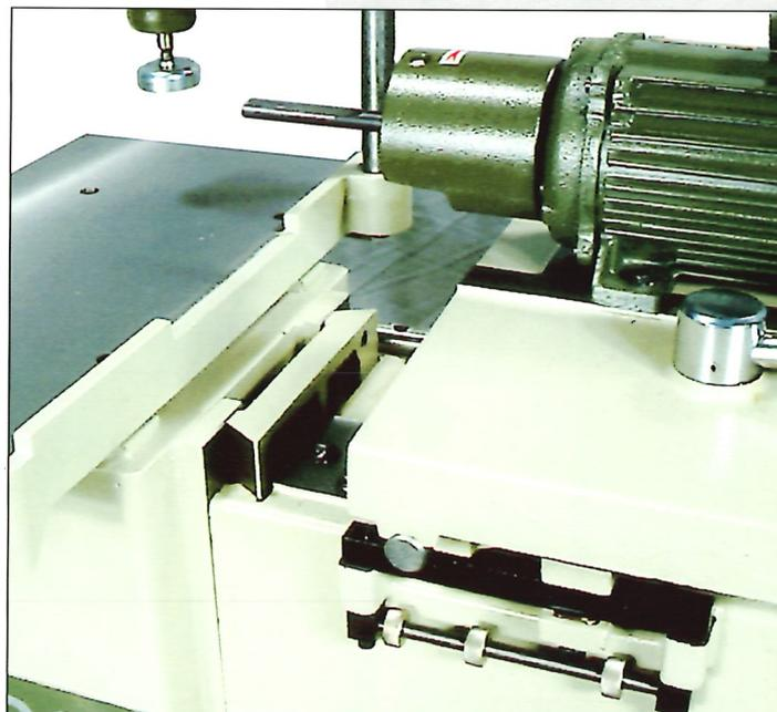
Die Stabilität und die Präzision sind durch ein Stahlstangengleitsystem und entsprechende Lager sichergestellt. Zwei einfach verstellbare Anschläge gewährleisten zudem konstante Fertigungsqualität bei gleichbleibenden Bearbeitungen.
