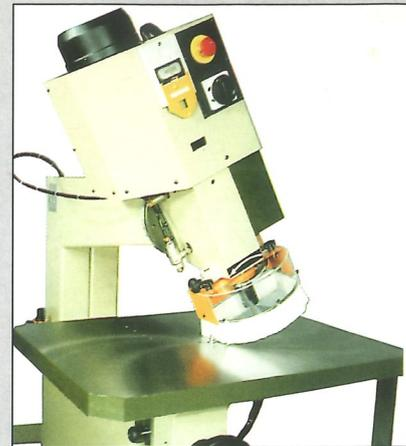
Die Revolvervorrichtung mit 6 Anschlägen beschleunigt die Einstellung der Maschine. Eine Absaughaube garantiert Sauberkeit und Sicherheit beim Arbeiten.
