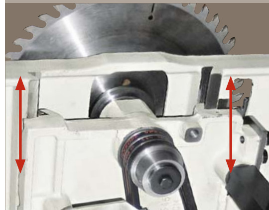
Sägeblatthub über eine starke Gussstruktur mit Schwalbenschwanzführung. ▶
