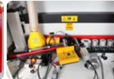
ÖN FREZE, ÖN ISITICI, TUTKALLAMA VE BASKI PRE HEATERS
