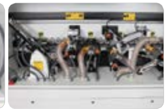
BAŞ SON KESME, FREZE VE KÖŞE YUVARLAMA FIRST END CUTTING, MILLING TRIMMING
