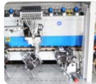
YENİ TRİM ÜNİTESİ NEW CORNER ROUNDING
