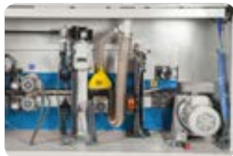
SICAK HAVA ÜFLEME, JAMPIGLI VE ÜNİVERSAL KANAL AÇMA HOT AIR BLOWER AND GROOVING UNIT WITH JUMPING SYSTEM
