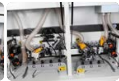
YENİ KÖŞE YUVARLAMA NEW CORNER ROUNDING
