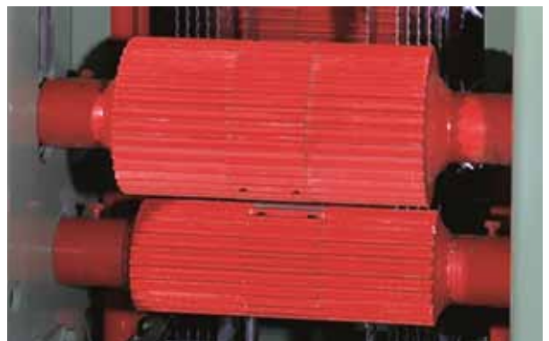
Walzeneinlagen aus Stahl
