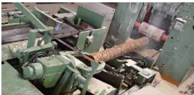
ferngesteuerter Spannwagen SWvh1
