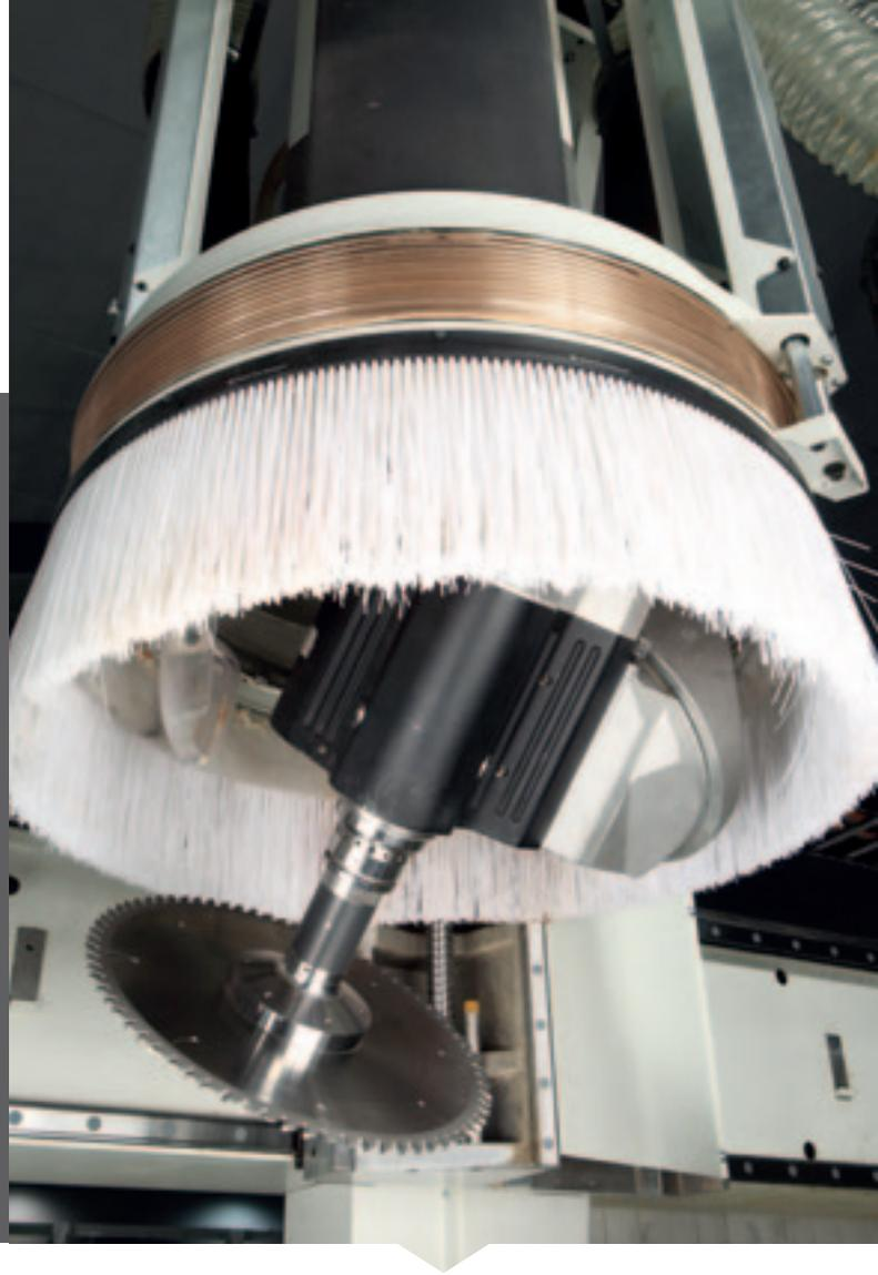
Fräsaggregate mit 3 oder 4 oder auch 5 Achsen und einer Leistung bis zu 15 kW, mit denen vertikale, horizontale, schräge Bearbeitungen und Schnitte mit Sägeblättern bis zu einem Durchmesser von 350 mm möglich sind. Jedes Aggregat ist auf einem unabhängigen Z-Wagen montiert, um die Bearbeitungshöhe vollständig zu nutzen.
