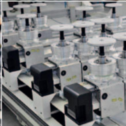
Der Arbeitstisch ist für Bearbeitungshöhen von 50 mm oder 110 mm mit Saugnäpfen und/oder mechanischen Spannvorrichtungen konfigurierbar.
