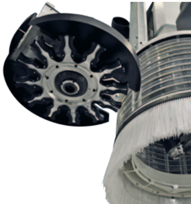
Durch das „On-Board“-Magazin Rapid 12, das direkt an der Hauptelektrospindel montiert ist, kann der Werkzeugwechsel taktzeitunabhängig erfolgen, während ein zusätzliches Aggregat bohrt oder fräst.
