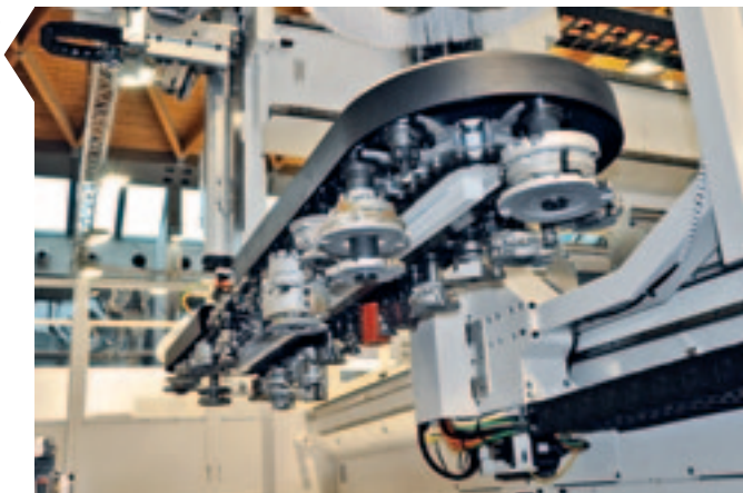
Kettenmagazin mit 48 Plätzen für große Werkzeuge mit einem Durchmesser bis zu 350 mm und einem Wechsler Shuttle, mit dem das Werkzeug in nur 5 Sekunden ausgetauscht werden kann.
