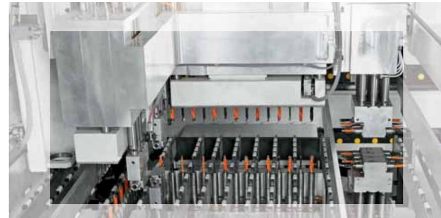
Die 3 pneumatischen Druckbalken mit kleinen Rollen gewährleisten das perfekte Halten der Platte auf dem Arbeitstisch in dem horizontalen Bohrbereich in X und Y Richtung, und für eine absolute Genauigkeit in der Z-Ebene.
