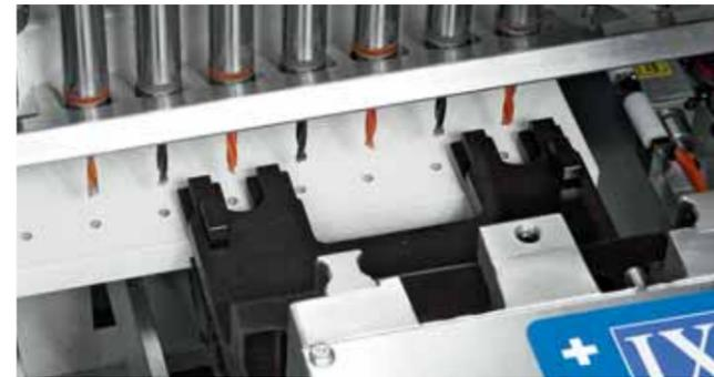
Die Platten-Spannzangen mit einer neuen Geometrie und unabhängigen Bewegungen in X-Richtung bieten die Möglichkeit, auch an Stellen innerhalb der Zange Bohrungen vorzunehmen, und die Neupositionierung der Spannzangen zu optimieren, die Zykluszeiten zu senken und die Bearbeitung auf allen 6 Plattenseiten zu ermöglichen.
