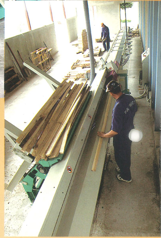
Različni tipi podmiznih klasičnih in CNC pnevmatskih ali hidravličnih čelilnih linij. Verschiedene Typen der konventionellen und CNC pneumatischen und hydraulischen Untertischkappanlagen. A range of classic and CNC pneumatic and hydraulic upcut crosscut saws.
