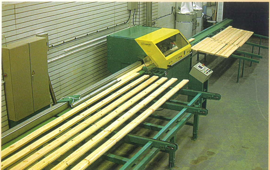
Linije za obdelavo brun za lesene hiše. Anlagen zum Bearbeiten der Balken für die Holzbauhäuser. Automatic systems for end profiling and notching for timber building construction.
