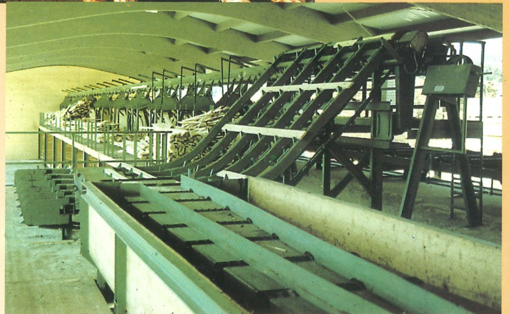
Linije za obdelavo brun za lesene hiše. Anlagen zum Bearbeiten der Balken für die Holzbauhäuser. Automatic systems for end profiling and notching for timber building construction.
