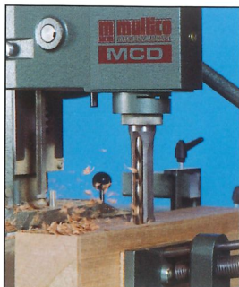
Das Hohlmeißelsystem von MULTICO liefert tiefe, präzise Langlöcher sowohl in Hart als auch in Weichholz, und anderen Materialien.
