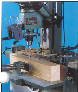
MULTICO-Stemmaschinen können bei Bedarf jederzeit als Langloch-Bohrmaschine eingesetzt werden.
