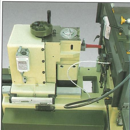
**2** Particolare della testa di bedanatura (OMB1 - ES2 - ES2B) con evidenziata la riga optoelettronica che controlla la profondità di lavorazione.
