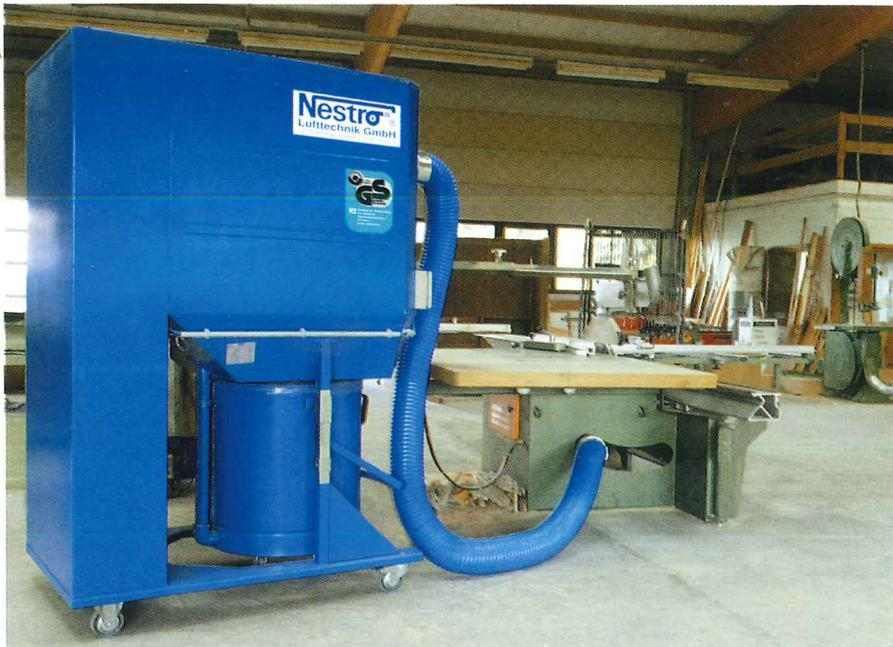
Nestro Entstauber Typ NE 160 an einer Formatkreissäge.
