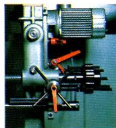
Ablängsäge mit Revolverkopfeinstellung und mit Schwenkmöglichkeit bis 45°.
