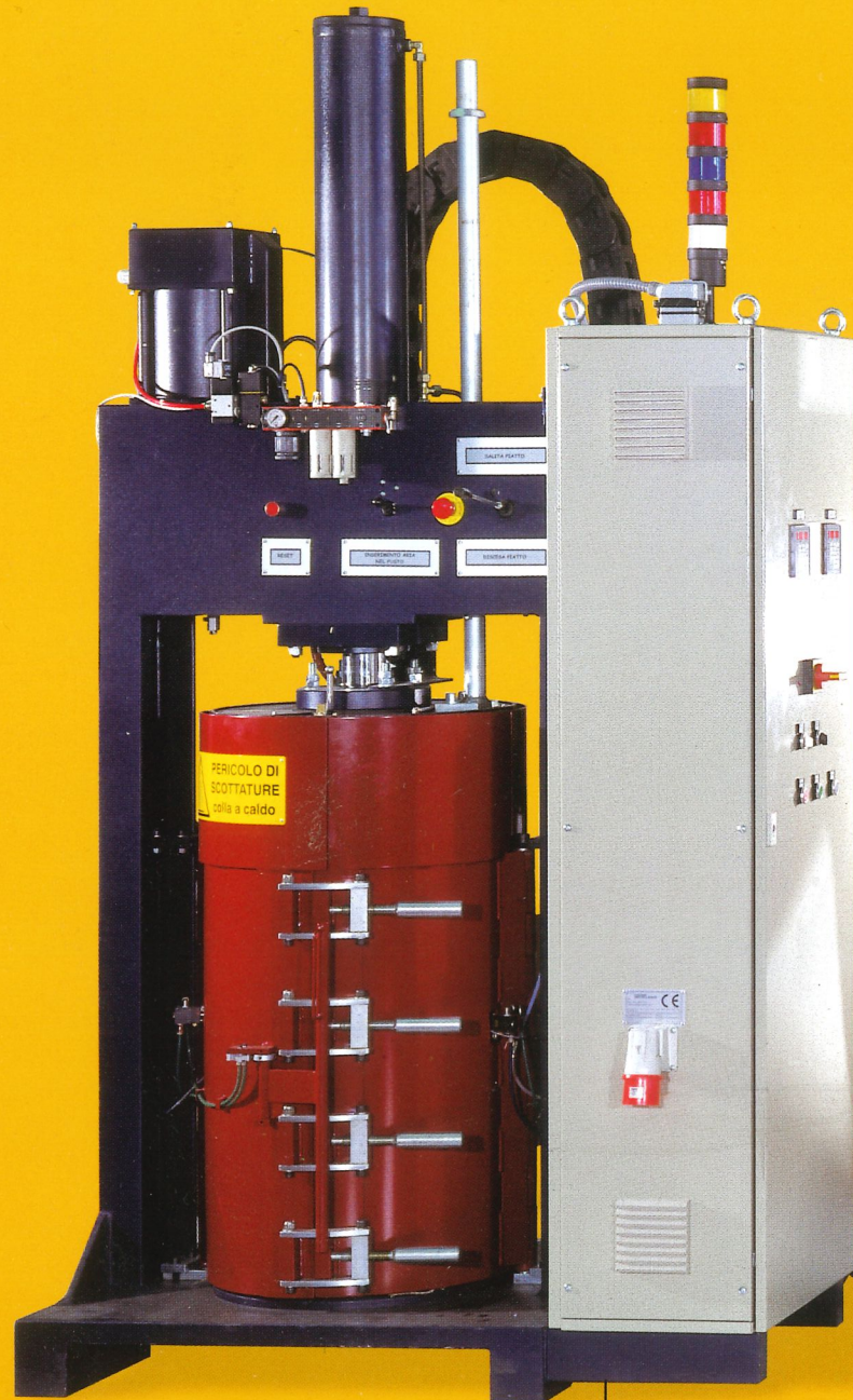
IMPIANTO ESTRUSIONE ADESIVO CON PIATTO PREMENTE RISCALDATO EXTRUSION ADHESIVE PLANT WITH HEATED PLATE
