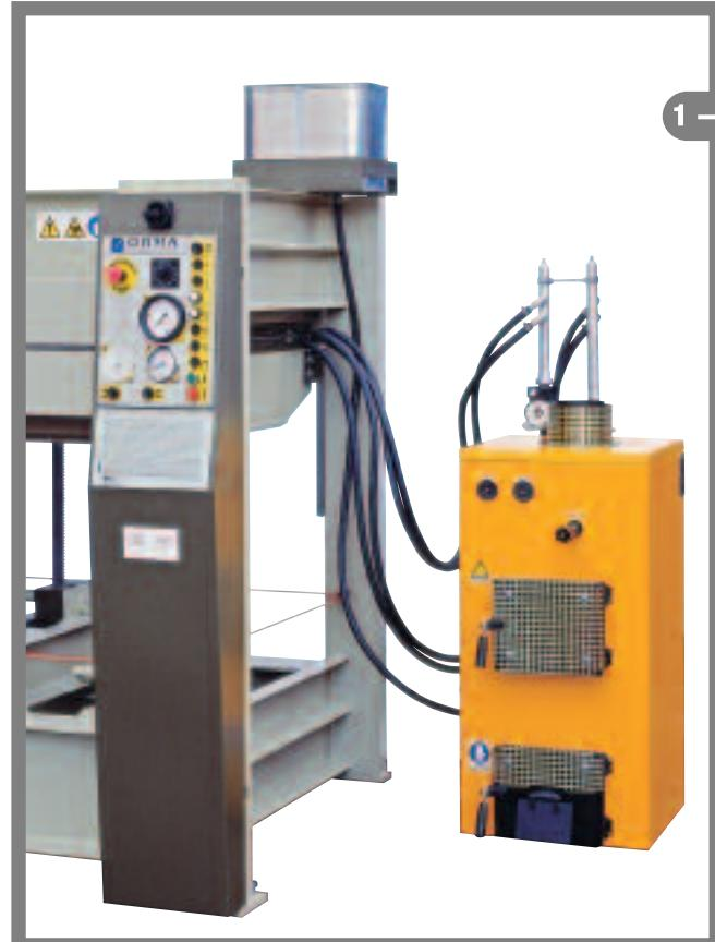
*Impianto di riscaldamento con boiler elettrico completo di pompa di circolazione, tubazioni di raccordo e vaso espansione.*
