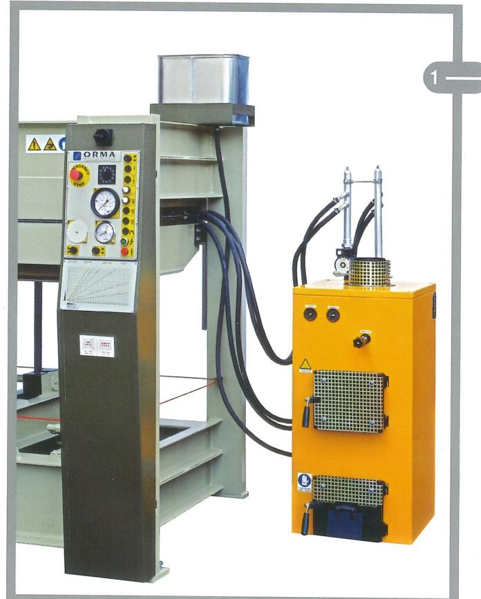
*Impianto di riscaldamento con boiler elettrico completo di pompa di circolazione, tubazioni di raccordo e vaso espansione.*
