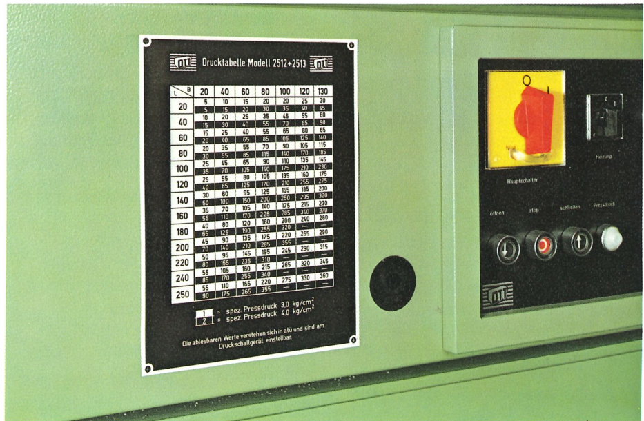
Drucktabelle mit 2 Wertangaben für Voll- und Teilbelegung der Preßfläche
