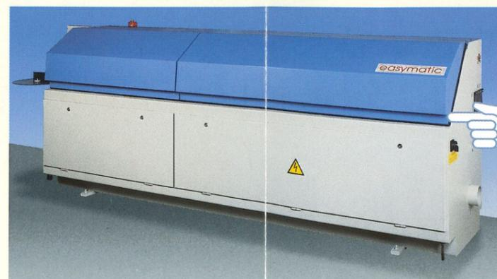
Völlige Kapselung der Maschine für optimierte Lärm- und Staubemissionswerte sowie höchste Bediener-sicherheit!
