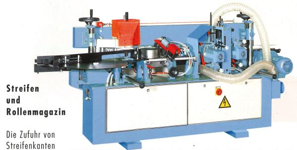
Die Zufuhr von Streifenkanten erfolgt bei den Modellen UNIKANT in Stand
