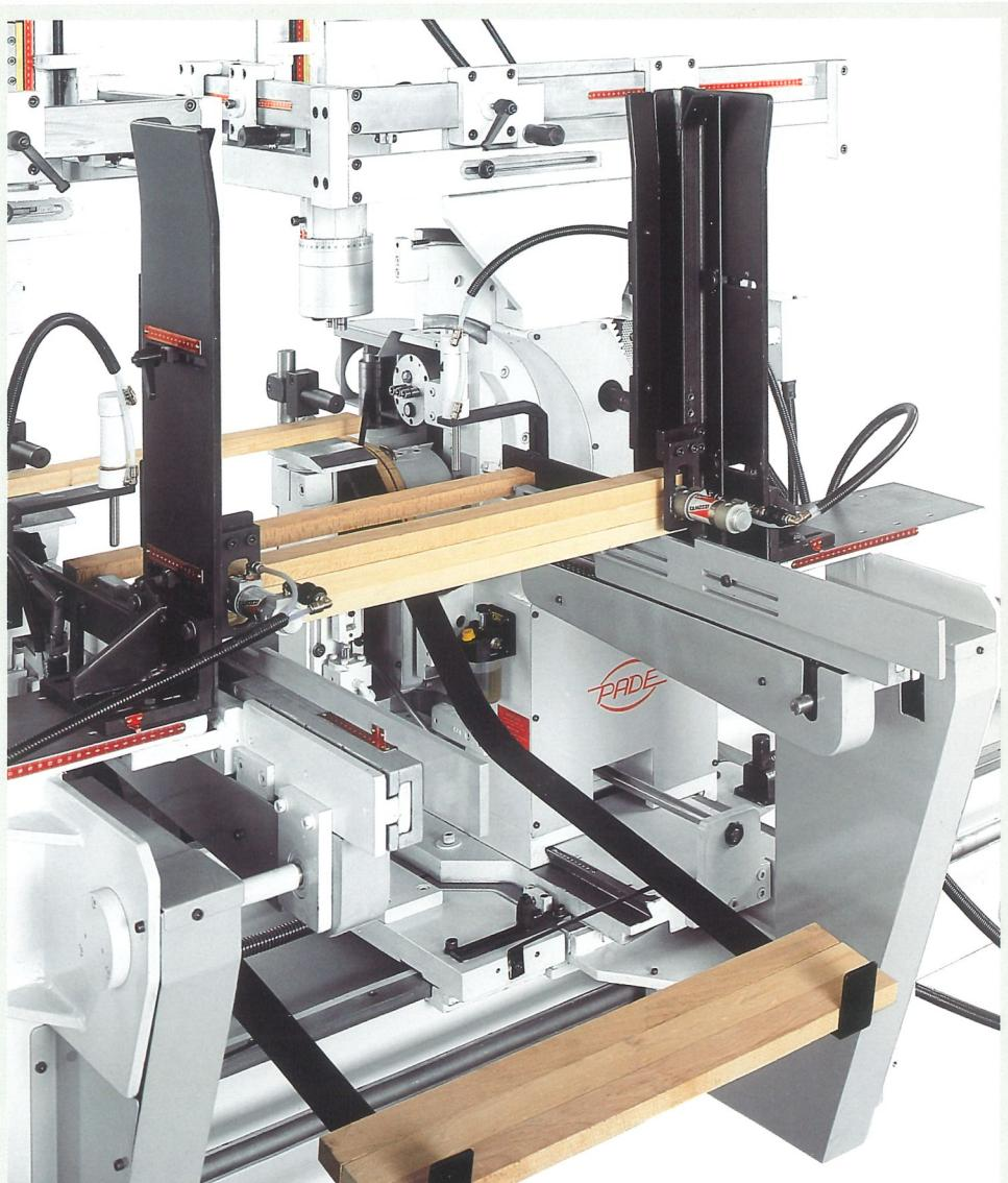
► NST con caricatore automatico modello CA e foratrici verticali ► NST with automatic hopper feeder model CA and vertical boring units ► NST mit automatischem Beschickungsmagazin Modell CA und vertikale Bohreinheiten ► NST avec chargeur automatique modèle CA et unités de perçage verticales ► NST con cargador automatico modelo CA y unidades taladradoras verticales
