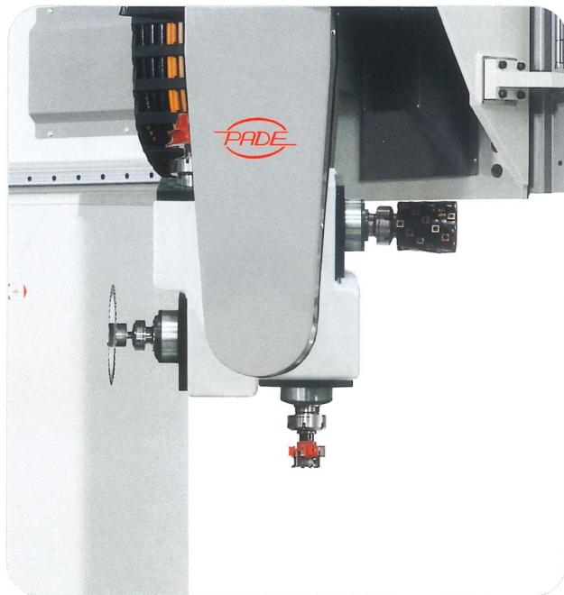
**C U S C U I Z** Magazzino portautensili del tipo a disco a 8 posti (12 opzionali), posizionato sul lato sinistro della macchina, con rotazione gestita da asse supplementare CN di posizionamento. Il cambio utensile è effettuato da un motore della testa T4 oppure T5, con portautensili tipo HSK F63.
