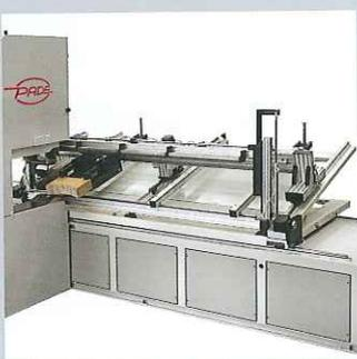
>> Centro 3 assi per il taglio di assi in legno o pannello. Rotazione della lama da  $-90^\circ$  a  $+90^\circ$  con movimento controllato. Garantisce tagli perfetti e regolazioni rapide ed elimina totalmente il ricorso a controsagome e tracciatura manuale delle assi da tagliare. Disponibile in varie versioni con carico manuale, semiautomatico o completamente automatico.
