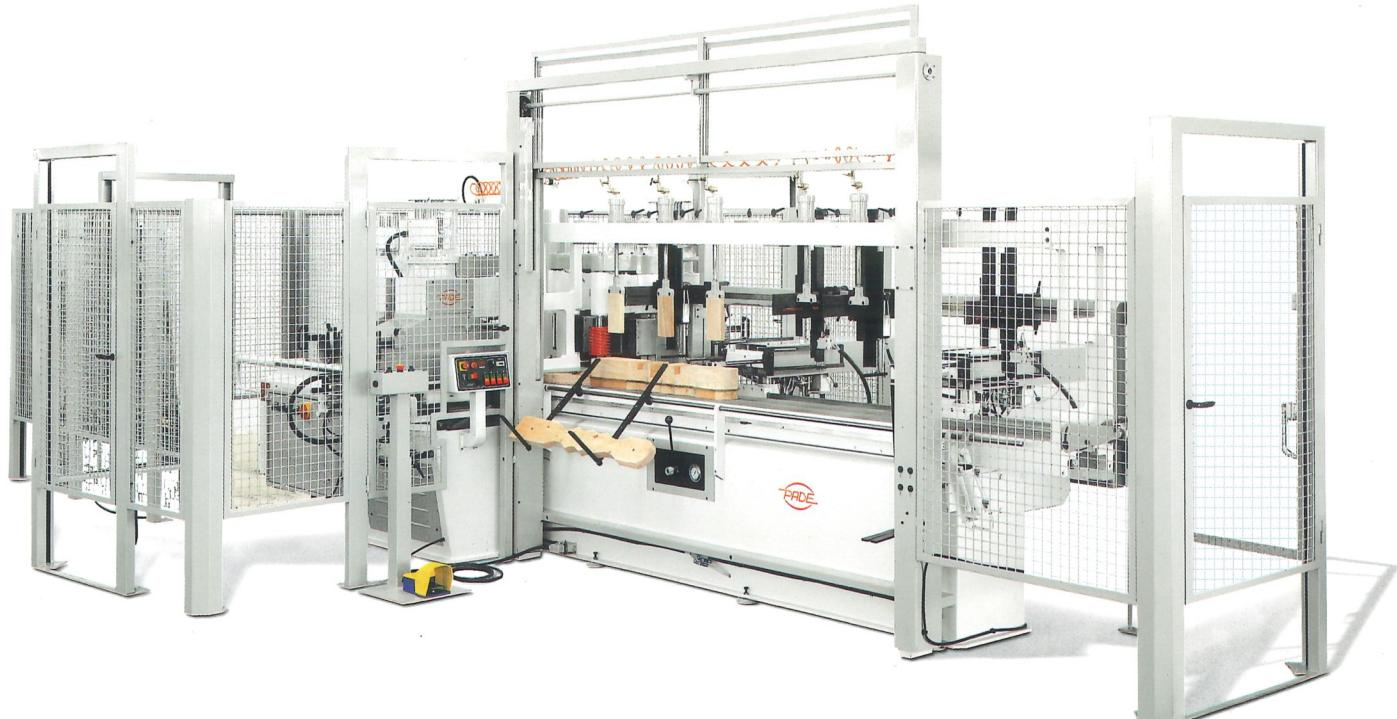
► Macchina UINZE 4T con normativa CE. Versione con caricatori automatici (opzione) ► Machine UINZE 4T with CE safety protections. Version with automatic hopper feeders (optional) ► Maschine UINZE 4T mit CE Sicherheitsausstattung. Version mit automatischen Beschickungsmagazinen (optionell) ► Machine UINZE 4T avec protections CE. Version avec chargeurs automatiques (option) ► Maquina UINZE 4T con normativa CE. Modelo equipado de cargadores automaticos (opcional)
