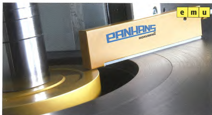
Zeromaster-Referenzmaßstellgerät, sorgt für kurze Rüstzeiten bei der Werkzeugkalibrierung
