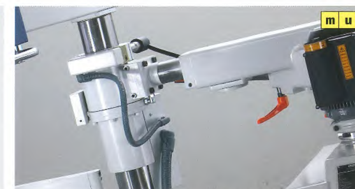
Comfort-Vorschub-Tragarm, elektromotorisch höhenverstellbar, Positionierung über Achsenmodul
