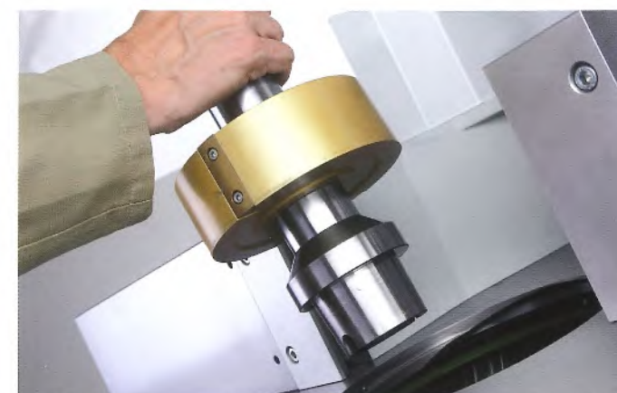
Fräsdorn-Schnellwechselsystem HSK, mit automatischer elektromechanischer Spindelarreterung
