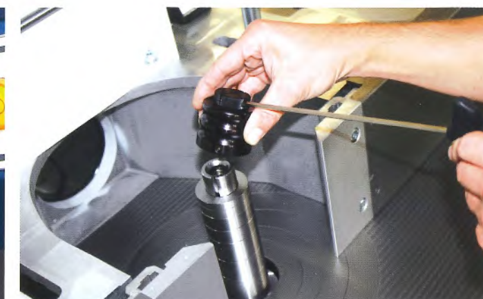
Komfortabler Werkzeugwechsel durch Fräser-Schnellspanneinrichtung
