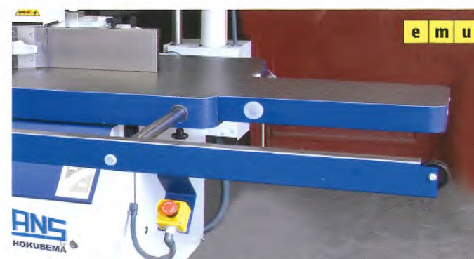
Tischplattenverlängerung einseitig/beidseitig, mit ausziehbarer Rahmenauflage
