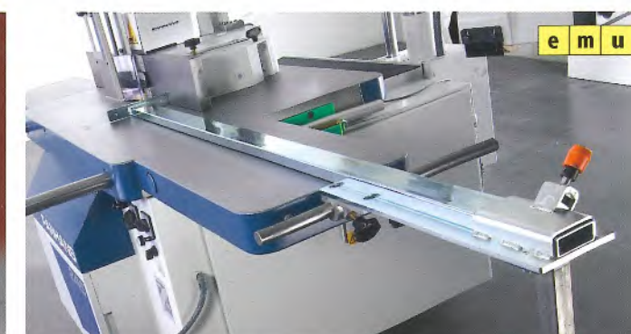
Rückschlagschutz Typ 1648, zum sicheren Einsetzfräsen
