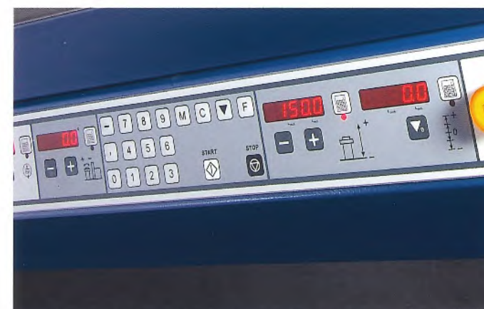
2-Achs-Positionssteuerung zur Höhen- und Schwenkverstellung
