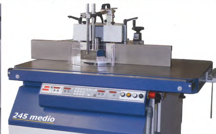
Große Tischplatte, mit nach links versetzter Spindel, schafft eine große Auflagefläche
