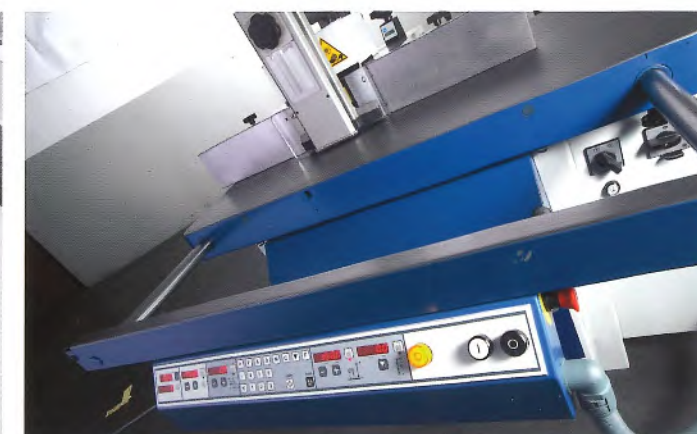
Rahmenauflage 1340 mm ausziehbar bis ca. 970 mm
