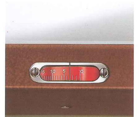
Die Einstellung der Spanstärke geschieht nach Skala.
