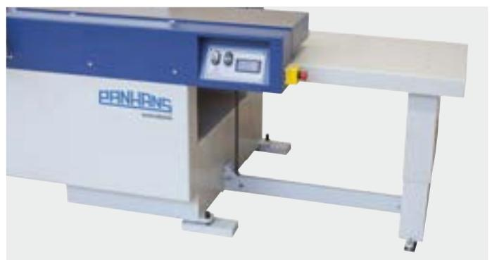
**Option.** Durch die Dickentischverlängerung lässt sich die Arbeitsfläche um 1000 mm erweitern. Die Höhenanpassung erfolgt automatisch.
