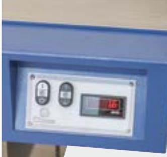
**Einfache Bedienung.** Mit übersichtlichen Tasten werden die erforderlichen Maße für das Abrichten (l.) und das Dickenhobeln (r.) eingestellt.
