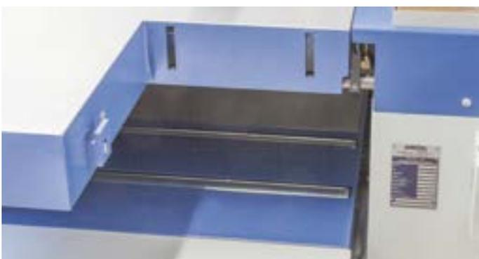
**Option.** Der zuschaltbare Austransport sorgt dafür, dass Kurzteile ab ca. 320 mm aus der Maschine herausbewegt werden.
