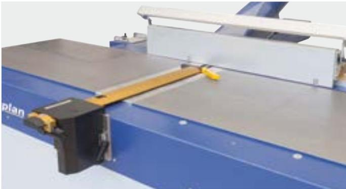
**Große Arbeitsfläche.** Die Abrichttische sind feingehobelt mit optimalen Gleiteigenschaften. Das stabile Anschlaglineal lässt sich weit nach hinten fahren für eine Arbeitsbreite von 630 mm.
