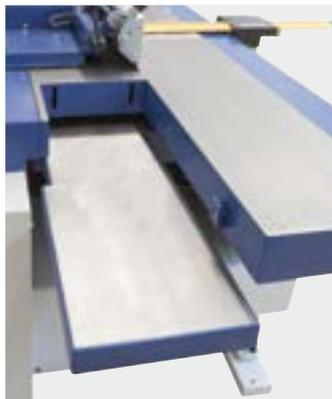
**Schnelle Anpassung.** Segmente des Arbeitstisches lassen sich zur Umstellung auf die Dickenhobelfunktion rasch verstellen.
