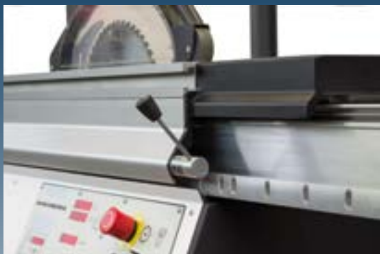
Chariot à double guidage souple et sans entretien
