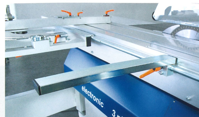
Zusätzliche Auflage für große Platten • Additional support for panels of large dimensions • Soporte adicional para tableros grandes
