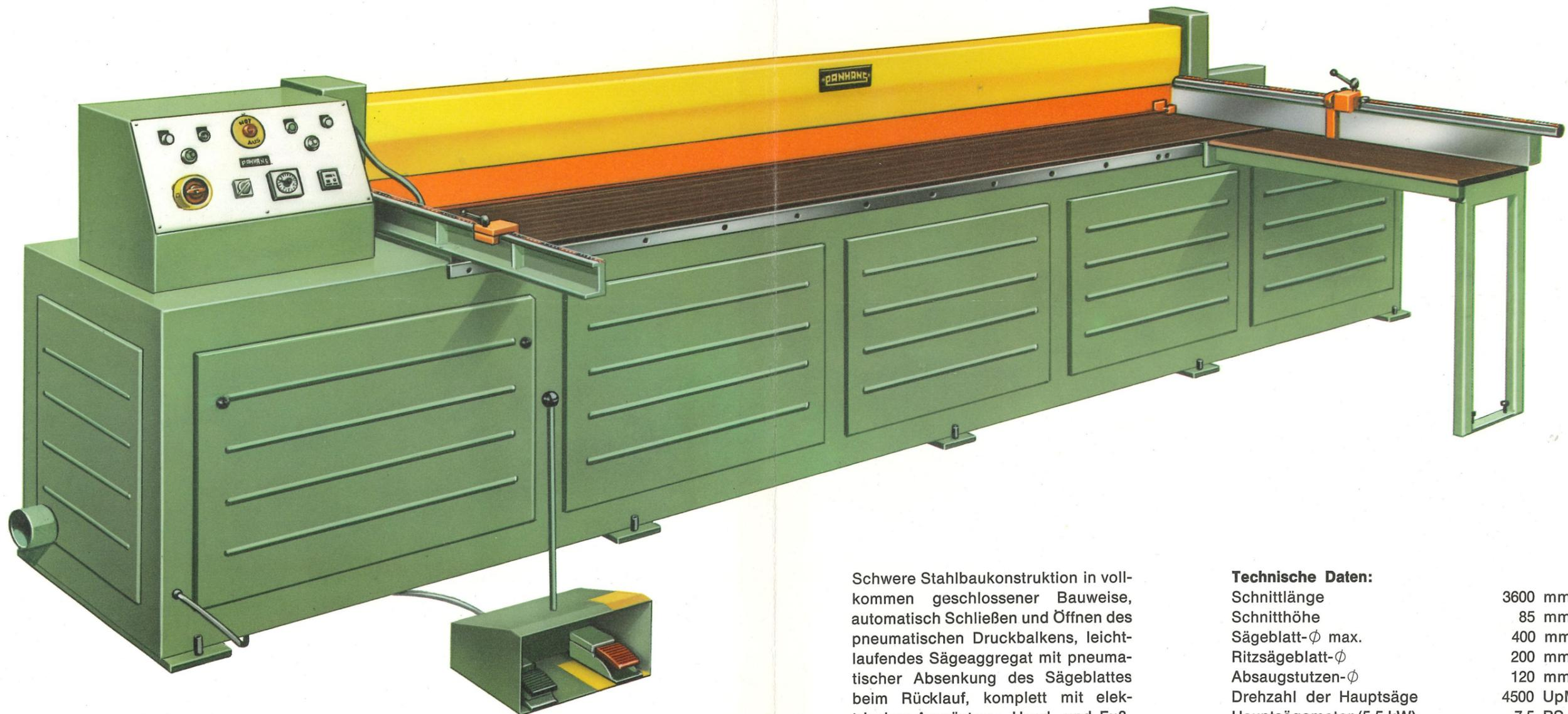
Schwere Stahlbaukonstruktion in vollkommen geschlossener Bauweise, automatisch Schließen und Öffnen des pneumatischen Druckbalkens, leichtlaufendes Sägeaggregat mit pneumatischer Absenkung des Sägeblattes beim Rücklauf, komplett mit elektrischer Ausrüstung, Hand- und Fußschaltung, stufenlose elektrische Schnittlängeneinstellung, Absaugkanal; das Schnittgut wird während des Schneidvorganges durch den Druckbalken beidseitig gespannt und deckt das Sägeblatt vollkommen ab.
