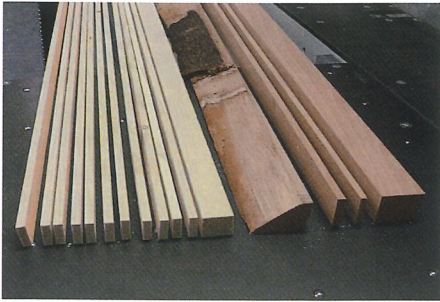
Der Anleimerzuschnitt mit schmalen Sägeblatt erbrachte einen sparsamen und schnellen Zuschnitt bei verleimfähiger Schnittqualität.
