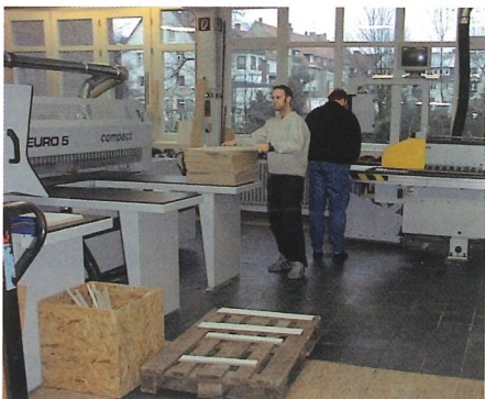
Weiterleitung der fertig formatierten Werkstücke direkt an die Kantenanleimstation.
