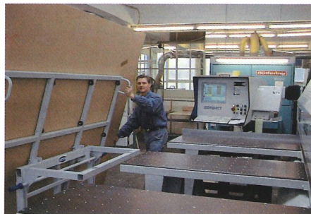
Auflegen einer Standardplatte durch eine Person mit dem Schmalz-Transportwagen.
