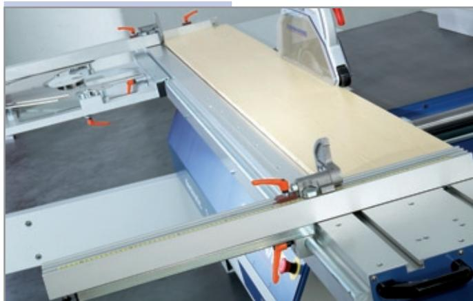
**Butée parallèle à gauche de la lame de scie**
