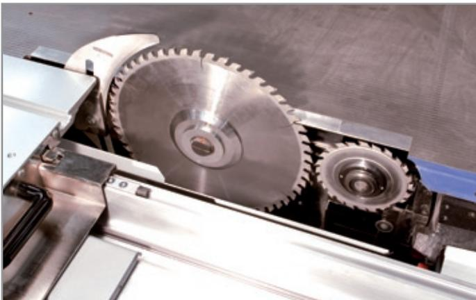
**Unité d'incisage avec système d'escamotage automatique AUTO-EPS** pas de salissure de la lame de scie d'inciseur en position parking, même avec lame d'inciseur montée.
