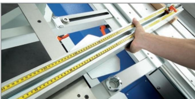
**Serrage confort pour butée longitudinales**
