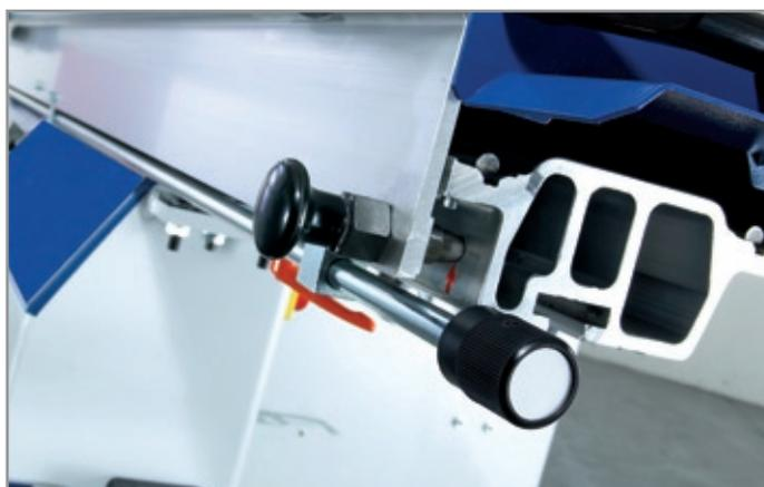
**Dispositif d'arrêt à distance pour chariot roulant**
