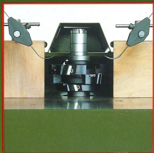
**T 140** Fresatrice verticale (Toupie) / Spindle moulder
