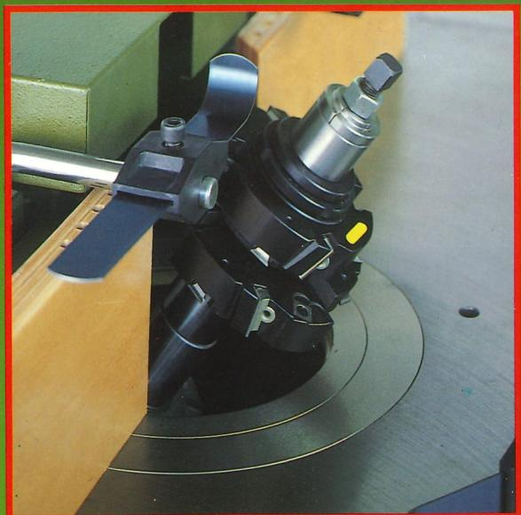
**TX 145** Fresatrice verticale (Toupie) / Spindle moulder Tischfräse
