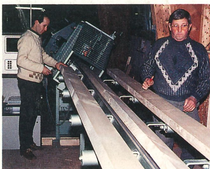
Abb. 6: An einer Doppelmаркиerstation können 2 Bedienungsleute gleichzeitig arbeiten.
