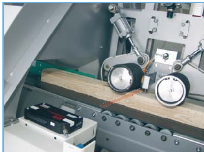
Abb. 6: Breitenvermessung (Option) in der Messstation
