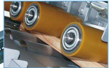
Abb. 12: Breite Vorschubwalzen garantieren eine optimale Schnittgutführung in der Kappstation
