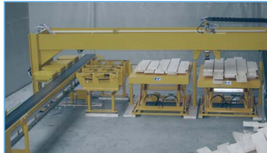
Abb. 19: Abschieber mit Vakuum Stapel- bzw. Entstapelanlage VacuSpeed
