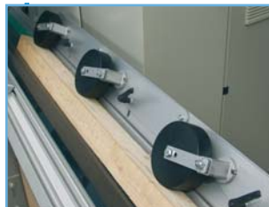
Abb. 11: Druckrolleneinheit zwischen Mess- und Kappstation
