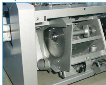
Abb. 14: Das Sägeblatt ist komplett gekapselt und leicht zugänglich
