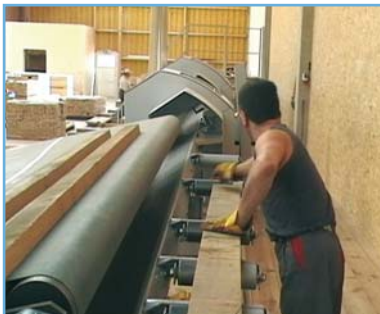
Abb. 5: Zuführung durch ein Förderband mit anschließender Fehlermarkierung
