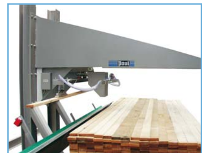
Abb. 22: Automatische Entstapelung "VacuSpeed"
