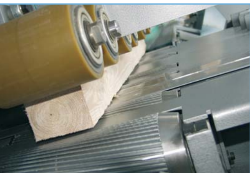
Abb. 1: Optimale Schnittgutführung im Sägebereich
