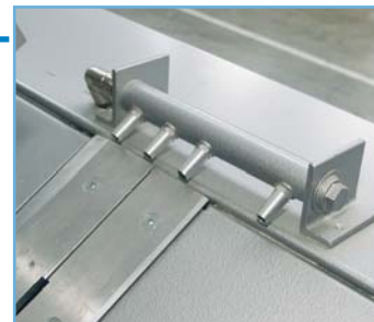
Abb. 13: Puster direkt am Sägeblatt
