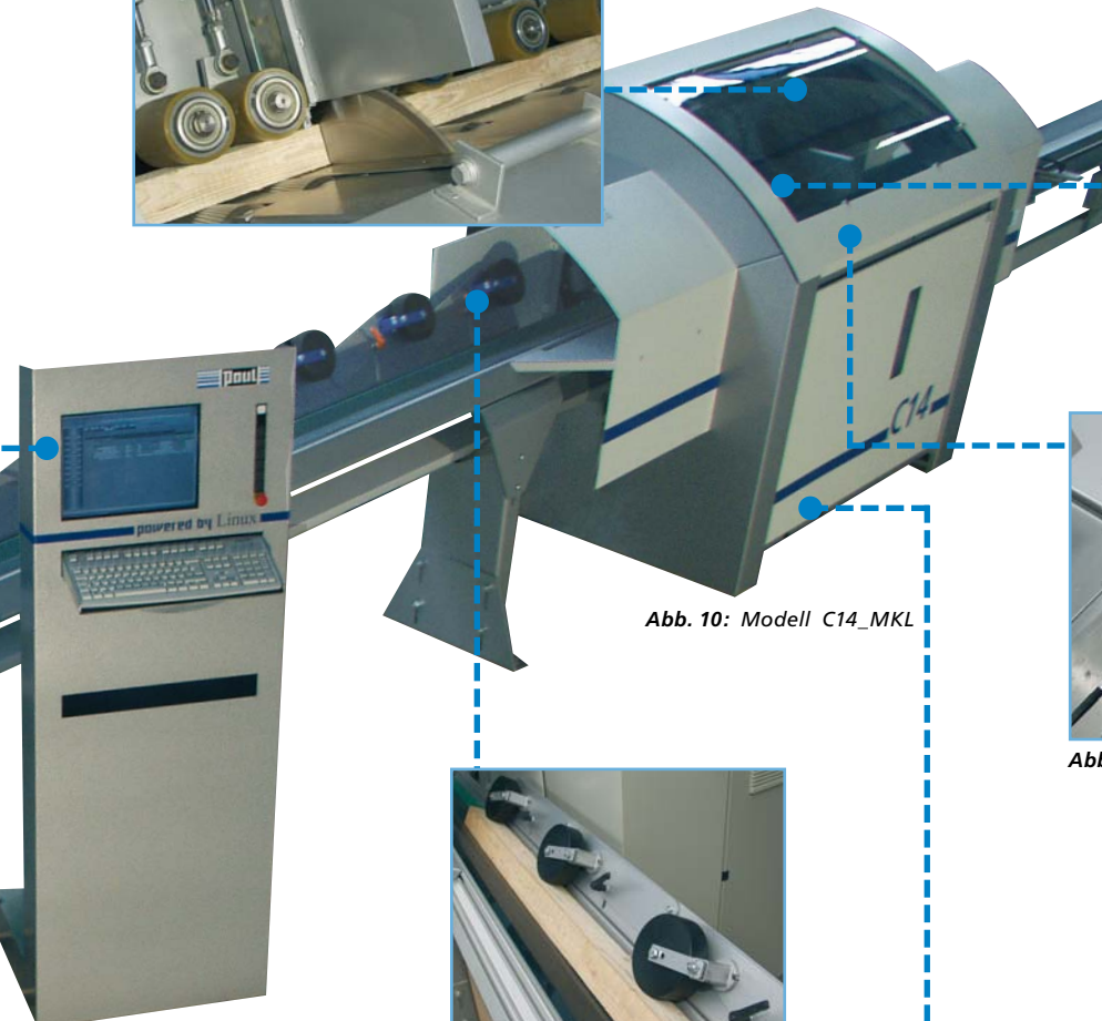
Abb. 11: Druckrolleneinheit zwischen Mess- und Kappstation
