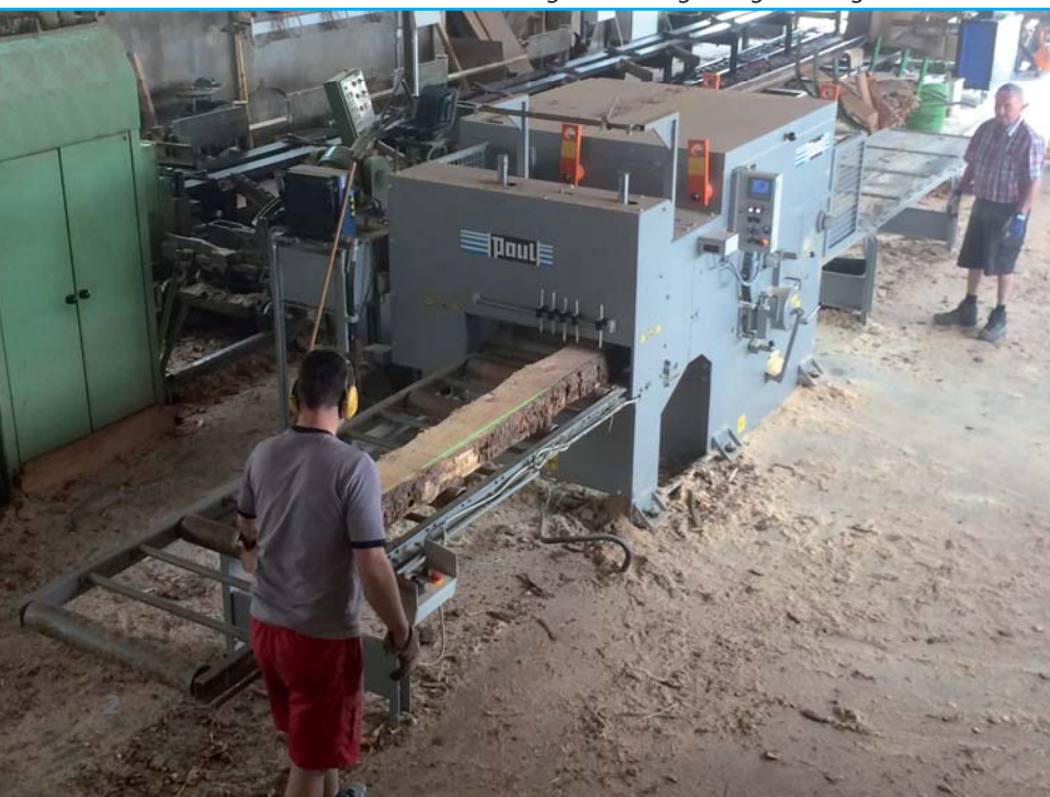
Abb. 2: S-918 mit manueller Beschickung und Einzugs-mangel im Sägewerk
