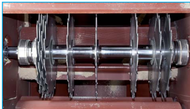
Abb. 11: Teleskopische Sägebüchsen-Anordnung für 4-stieligen variablen Einschnitt
