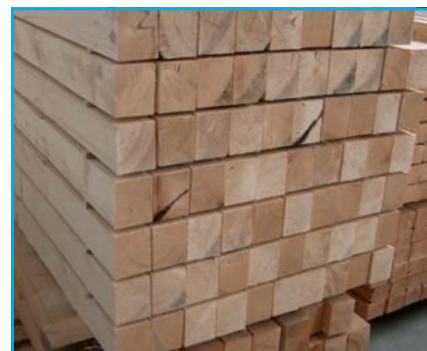
Abb. 9: ... zum Kantholz mit hervorragender Schnittqualität
