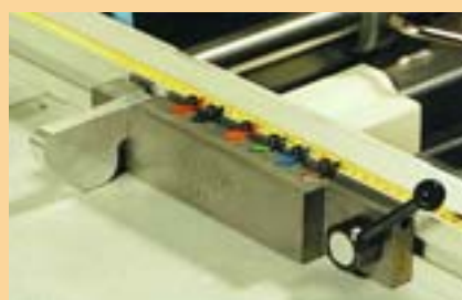
Règle aluminium inclinable de 0 à 50° avec butée escamotable et repères de couleurs
