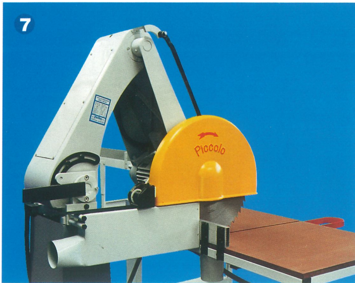
7 Detail: Schutz- und Sicherheitseinrichtungen Zwei Absaugstutzen Ø 100 mm, Überschlagsicherung mit Abdeckung des Sägeschlitzes am unteren Sägeschutz, Schnittweiten-Begrenzungsanschlag.
