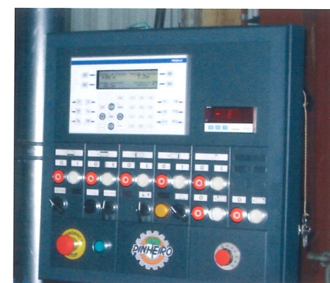
Pupitre de commande avec positionnement numérique deux axes et bois toutes largeurs
