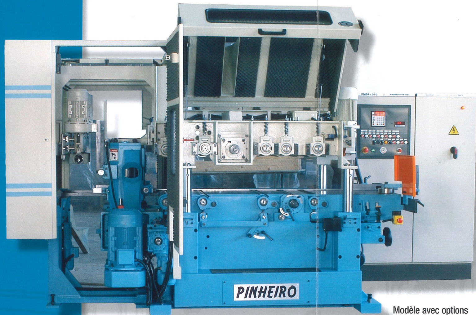
Pupitre de commande avec positionnement numérique deux axes et bois toutes largeurs
