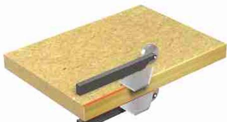
■ Gruppo raschiacolla con sistema pneumatico di autoallineamento per la finitura dei bordi plasticci sottili. Coltelli diritti per superfici piane e sistema di lubrificazione. Ingombro: 250 mm.
