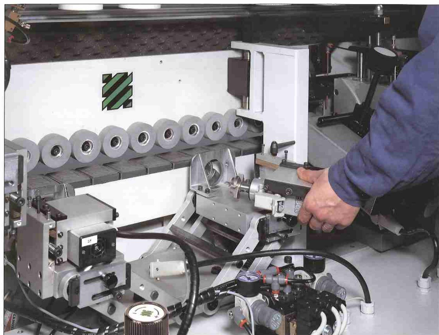
■ Un collaudato sistema meccanico per lo sgancio rapido dei motori, consente di effettuare la manutenzione, il cambio utensili o la integrale sostituzione del gruppo di lavoro. L'unità può essere estratta e sostituita in una sola operazione, mantenendo inalterate le regolazioni impostate ed evitando inutili tempi morti dovuti al cambio di lavorazione.
