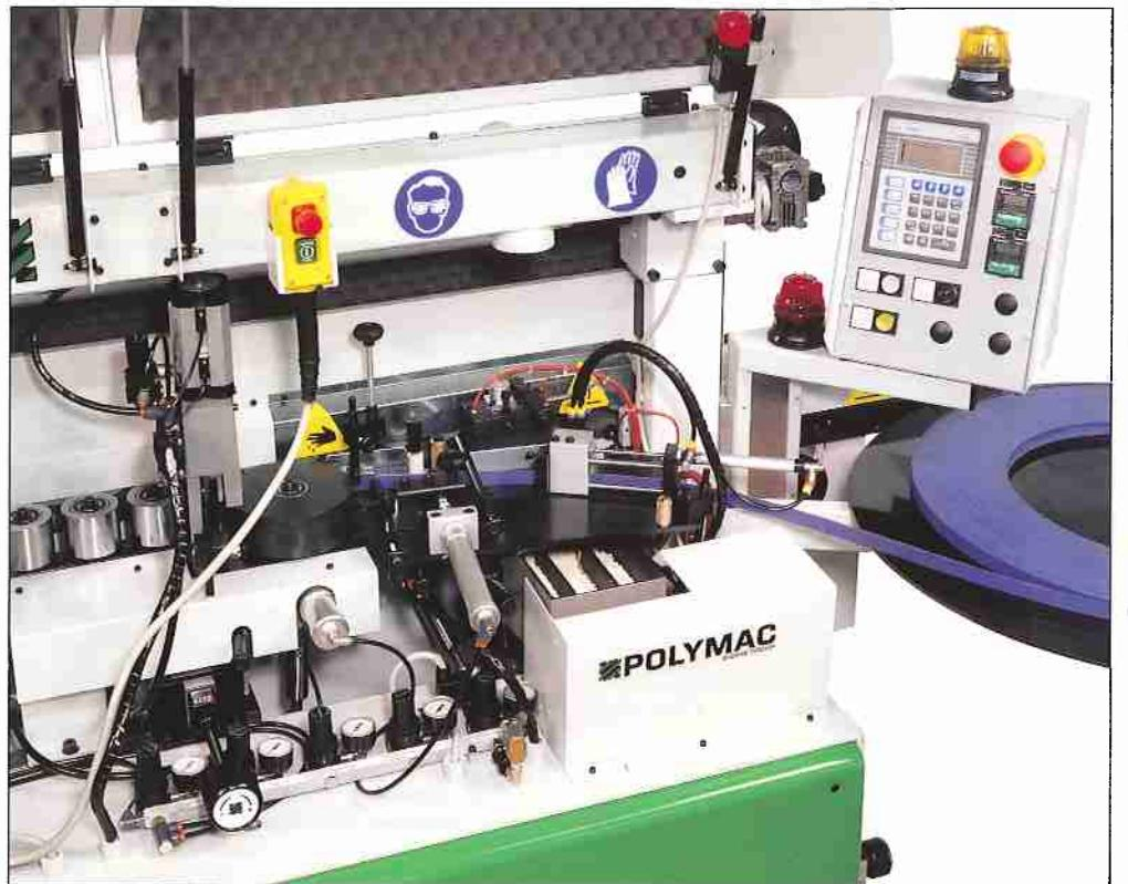
■ Vasca colla rivestita in teflon, caricatore con recupero pneumatico per bordi in rotolo ed ampio spazio di carico per strisce di massello pretagliato. Il perfetto incollaggio è garantito da un rullo motorizzato antiaderente e 3 rulli folli a pressione differenziata. Il controllo elettronico a PLC, con display e pulsantiera a membrana, rende semplice ed intuitivo l'uso delle funzioni della macchina.
