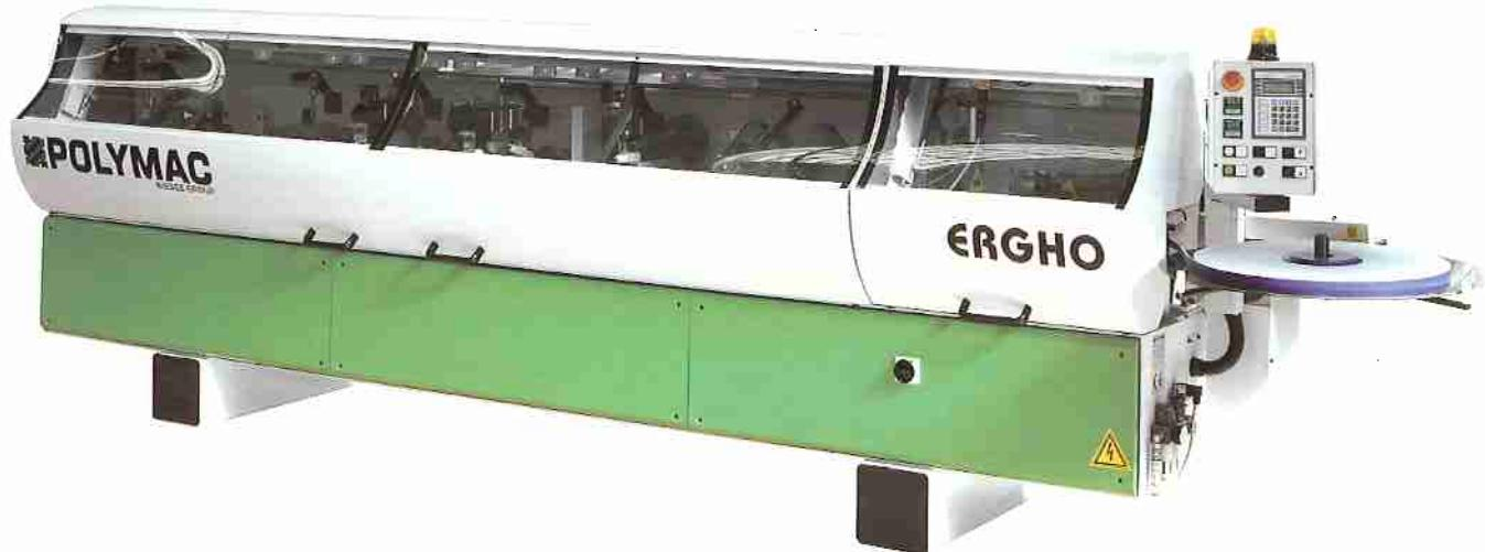
■ Le cabine di protezione integrali rivestite in materiale fonoassorbente, garantiscono la massima sicurezza durante le operazioni di bordura.
