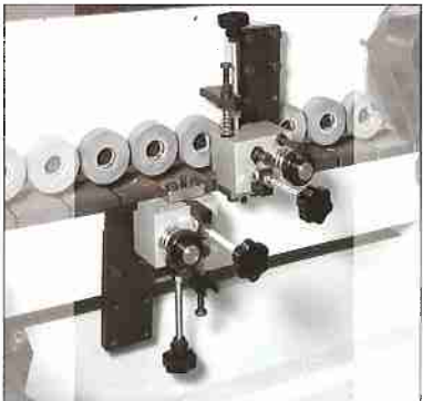
8) Gruppo lisciatore per la finitura dei bordi plastici di grosso spessore con coltelli a raggio. Copia a pattino orizzontali e verticali.
