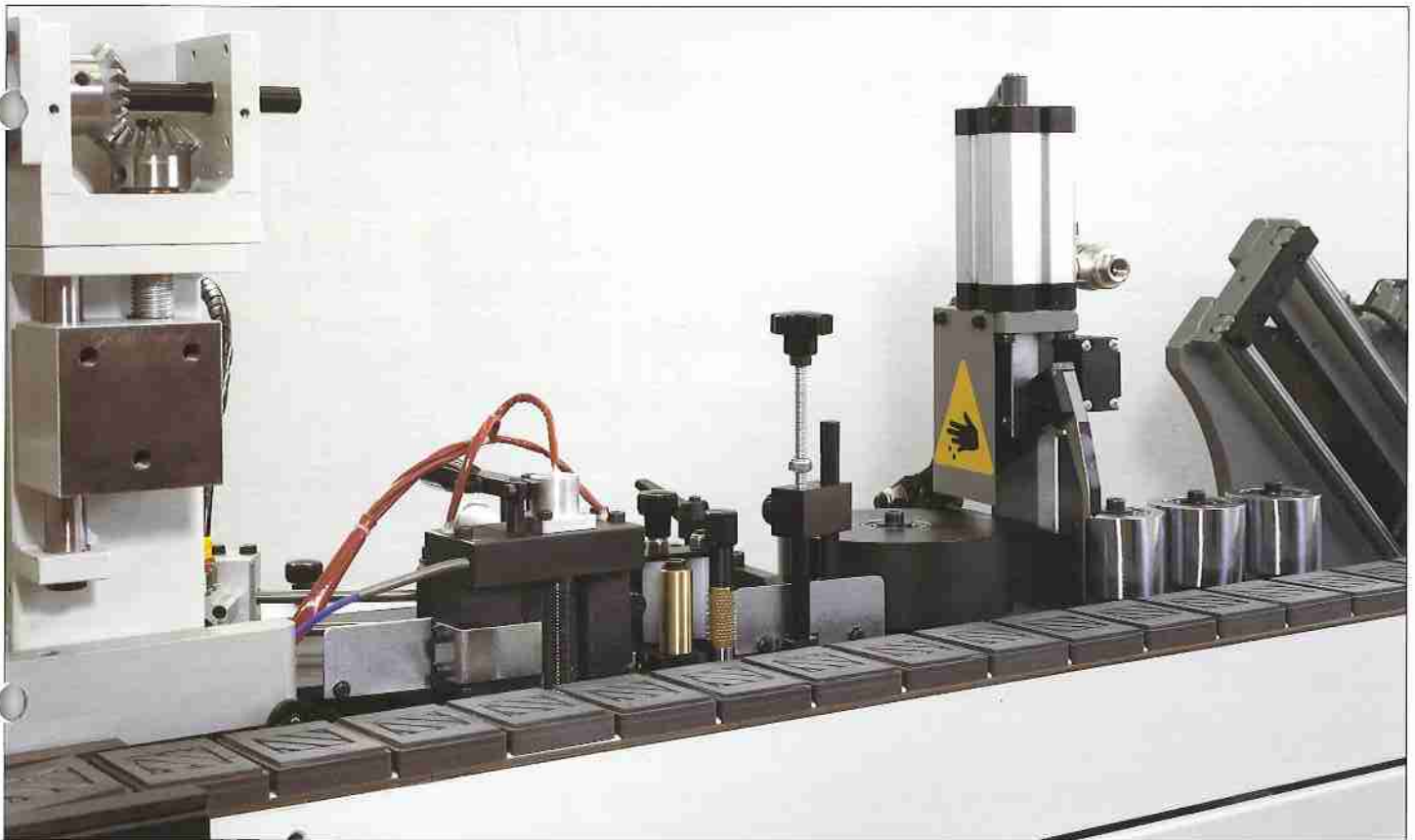
Zona incollaggio compatta: guida preriscaldante, vasca colla, caricatore, cesoia, rulli pressori. Compact glue area: pre-heating guide, glue tank, feeder, shears, pressure rollers.
