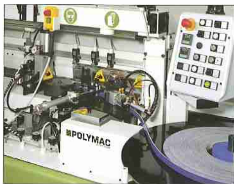
1) Gruppo incollaggio con vasca colla caricatore, cesoia con recupero bordi e rulli pressori. Versione con pulsantiera orientabile e comandi a microswitch.
