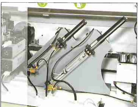
3) Gruppo intestatore 45° a taglio verticale con 2 motori indipendenti e inclinabili (2 x 300W 12000 g/i).
