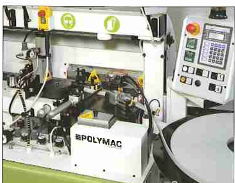
2) Gruppo incollaggio con vasca colla, caricatore, cesoia con recupero bordi pneumatico e rulli pressori. Versione con pulsantiera orientabile e comandi a PLC.
