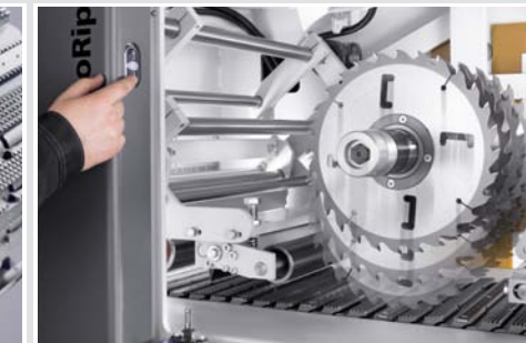
Elektrische Höhenverstellung der Sägewelle: hoher Bedienkomfort
