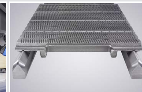
Prismengeführte Vorschubkette: beste Schnittergebnisse
