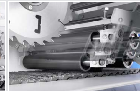
Elektrische Höhenverstellung des Druckwerks: hoher Bedienkomfort
