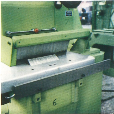
Zusätzlich vorgebauter Rückschlag- schutz, Modell K 23/31 additional pre-installed kick-back prevention guard, model K 23/31 dispositif de protection contre les retours des bois, modèle K 23/31
