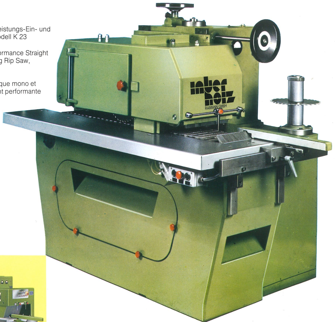
Automatische Ein- und Vielblattkreissäge mit einer oben- und untenliegenden Welle, Modell KD 23
